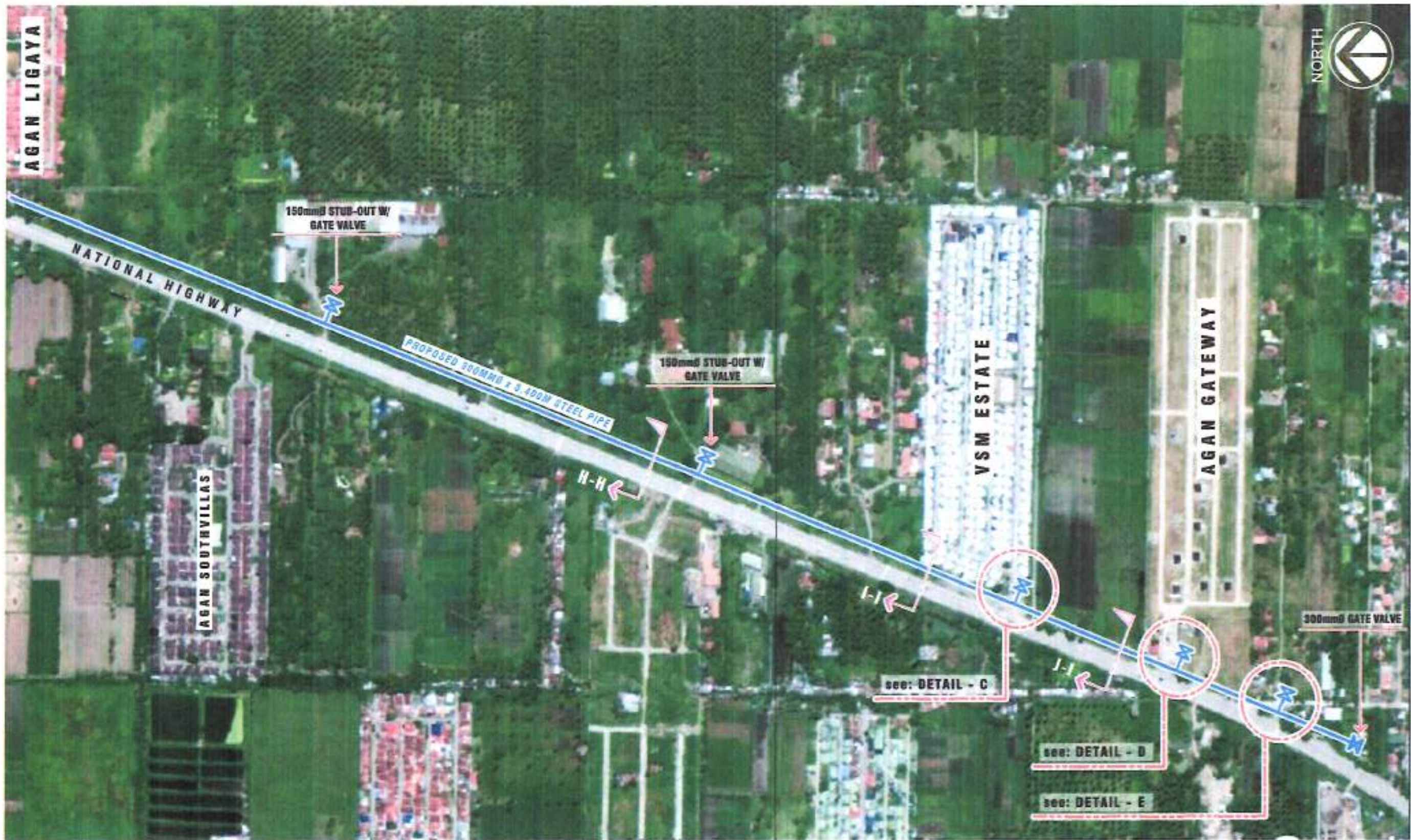
PIPE DISTRIBUTION LAYOUT SCALE: N.T.S.
