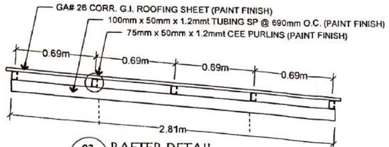
02 RAFTER DETAIL A-03 SCALE: 1:30 M
